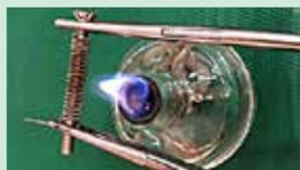
**Figura 3:** Arrotola la parte morbida della guida attorno al beccuccio e riscalda per alcuni minuti. Quando la guida si raffredda, tagliala a pezzi. Usa il core per raddrizzare i coils.
